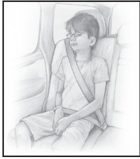
Figura 6: Cinturón de seguridad de regazo y hombros.
